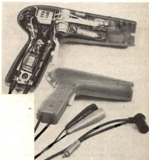
Fig. 1 - Pistola stroboscopica: si notano il cavo di alimentazione e il cavo che preleva l'impulso della scintilla.
